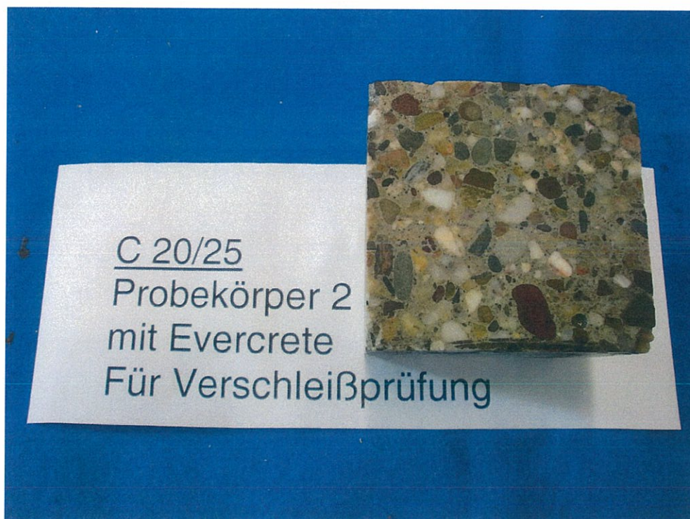
Bild Nr. 4: Probekörper 2 mit Evercrete nach der Verschleißprüfung
