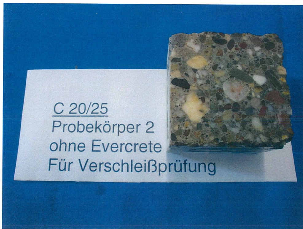
Bild Nr. 8: Probekörper 2 ohne Evercrete nach der Verschleißprüfung
