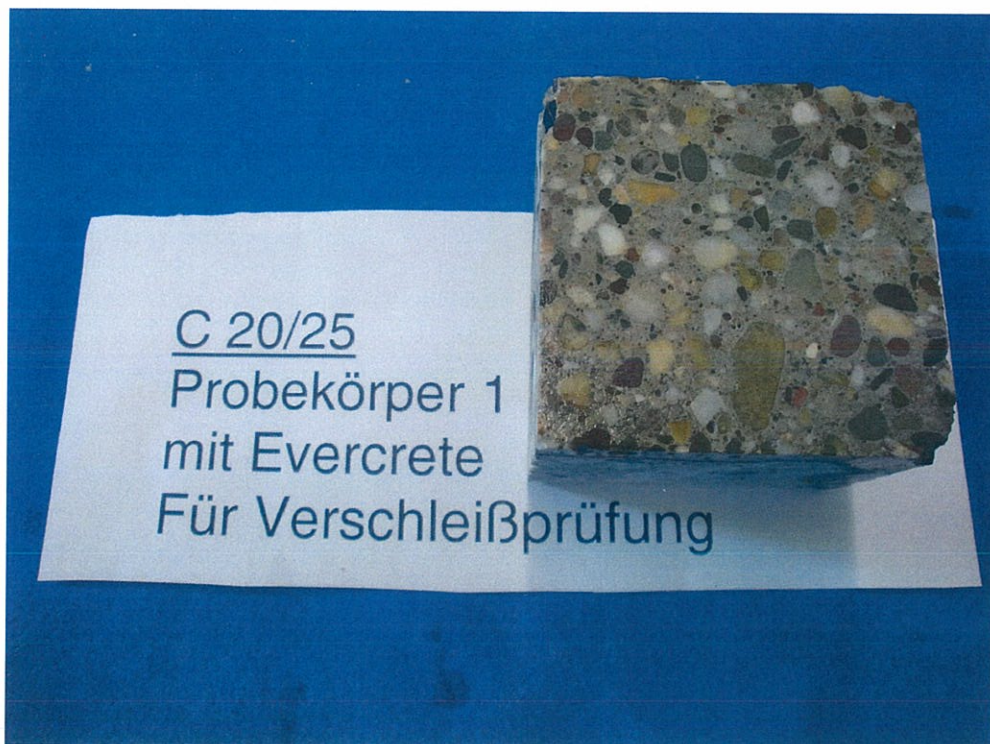
Bild Nr. 2: Probekörper 1 mit Evercrete nach der Verschleißprüfung
