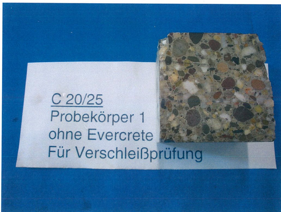
Bild Nr. 6: Probekörper 1 ohne Evercrete nach der Verschleißprüfung
